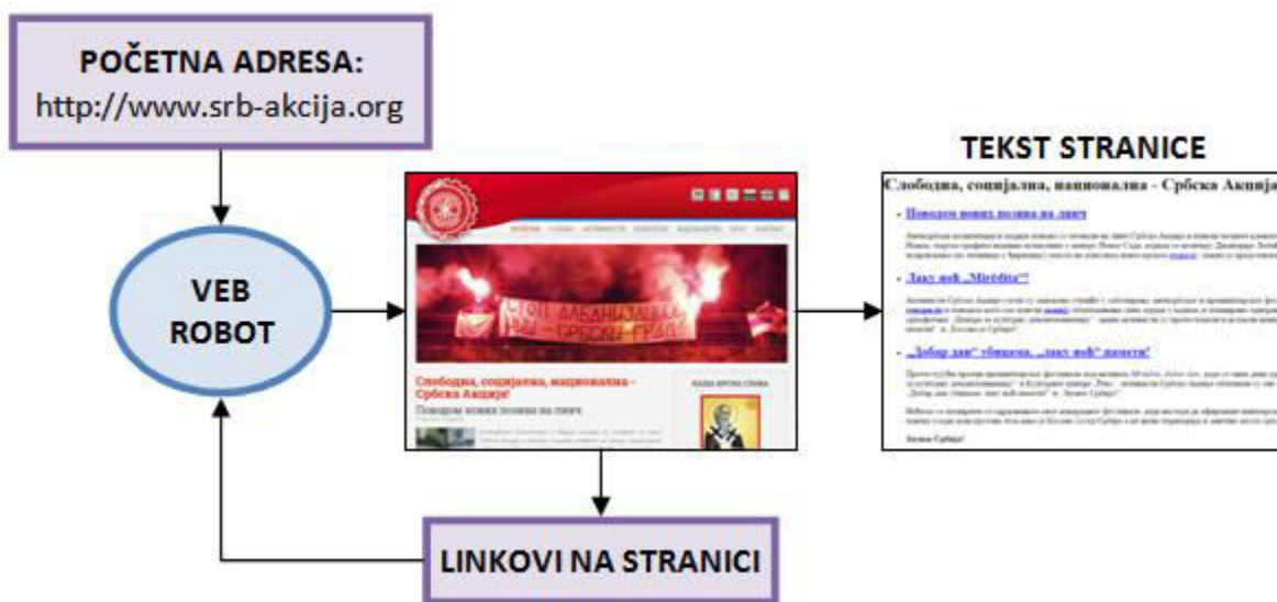
Slika 1. Automatsko prikupljanje veb stranica za potrebe web mining-a pomoću veb robota
